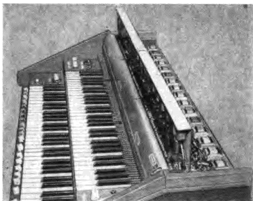
Bild 10.95 Ansicht des Registerteils des Instruments K4 nach Bild 3.4 (die obere Einbauebene ist hochgeklappt, die untere Einbauebene ist sichtbar)
