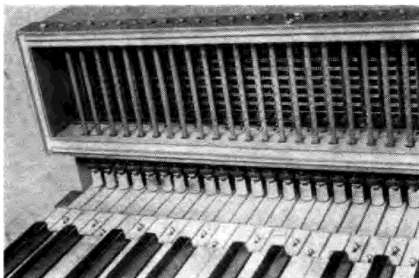
Bild 10.14 Tastenkontaktmechanik des II. Manuals
